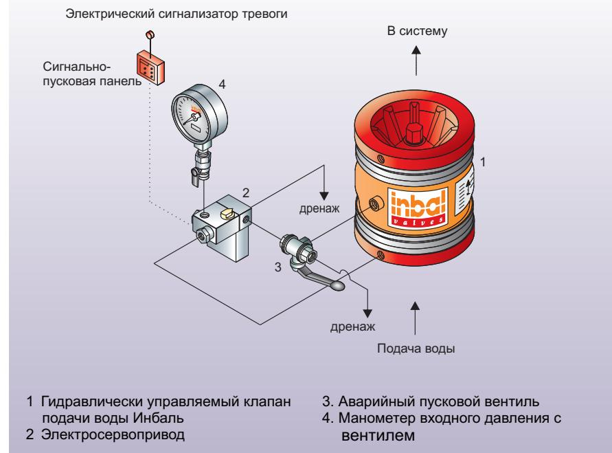
замедляя открытие и (или) закрытие узла управления клапана **Инбалль**. Такие функции обычно требуются при довольно большой протяженности трубопровода и (или) при его расположении под наклоном вниз, когда существует опасность гидравлического удара вследствие резких изменений скорости потока воды.
